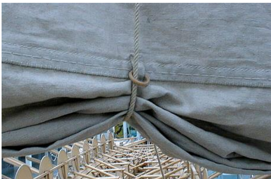
Рис. 37. Музей античного мореходства города Майнца. Деталь паруса (направляющее кольцо для горденя) реконструированного римского военного судна III в. н. э. (тип А по классификации музея).
