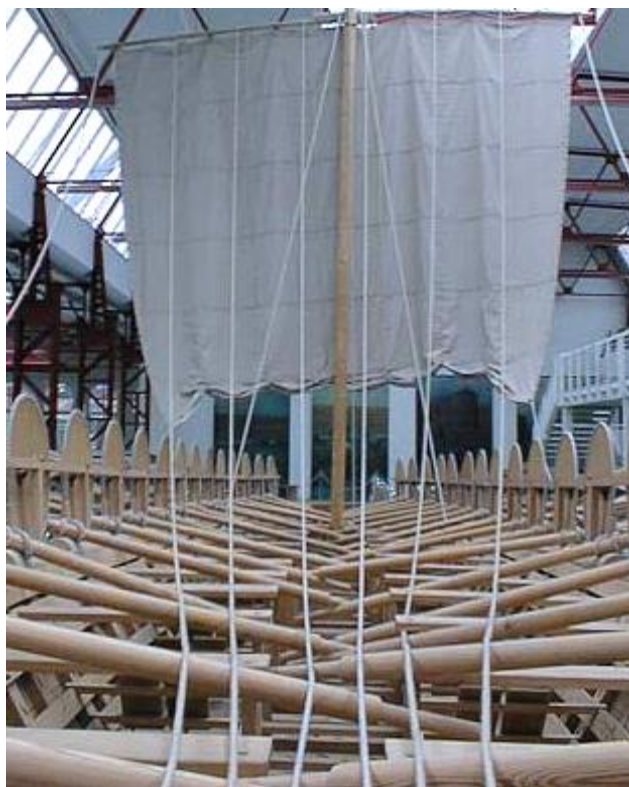
Рис. 36. Бык-гордени, идущие к корме. Реконструкция римского военного судна III в. н. э. Музей античного судоходства города Майнца.
